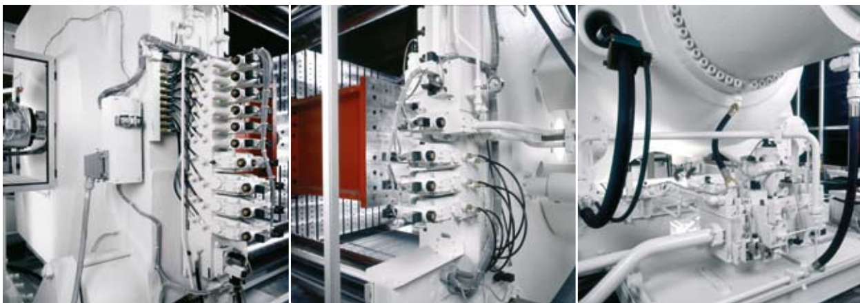
Feste Platte: Kernzug und Mould-Master- Ventile mit Proportionalventil Regelung
