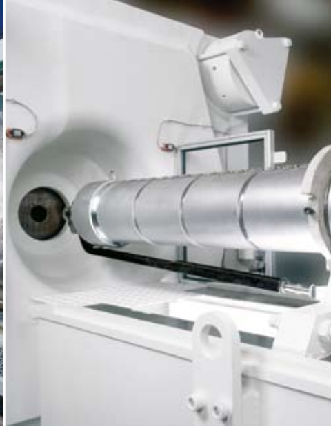
Immer die aufgabenspezifische An- und Aufbaulösung – zum Beispiel Plastifizierung mit Drehbolzenverschluss
