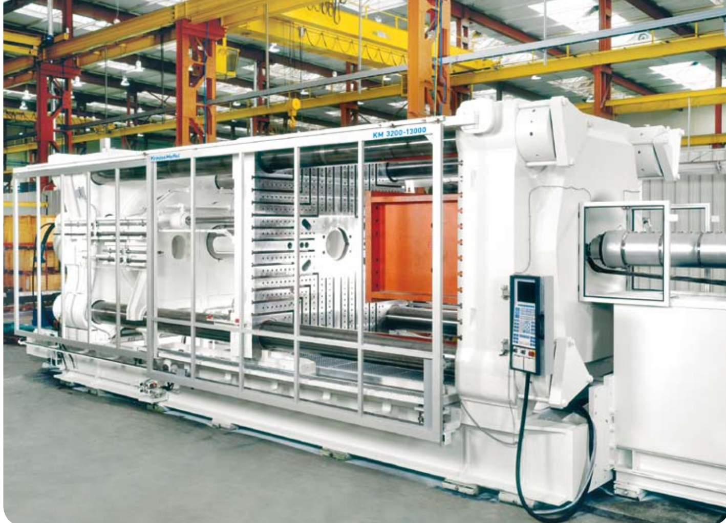
Schließeinheit nach Komplettmodernisierung
