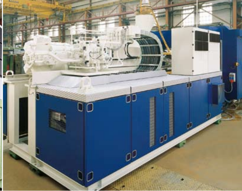
Ansicht des Hydraulikantriebs einer überholten Spritzgießmaschine.
