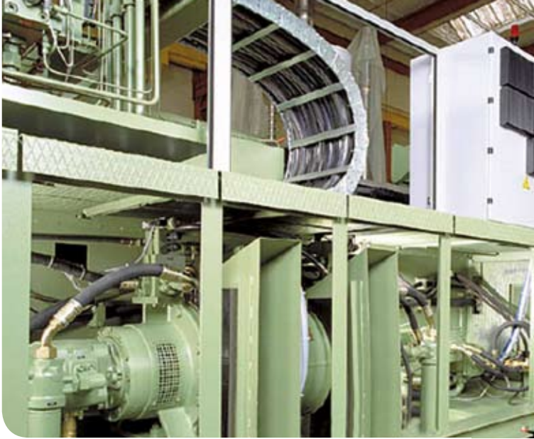
Auf Kundenwunsch wird dieser regenerative Pumpenantrieb mit entsprechender Energieeinsparung eingebaut.
