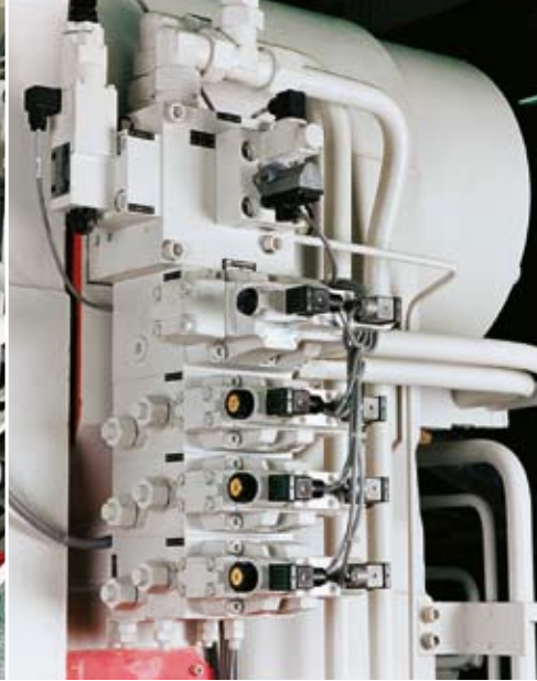
Modulares Konzept für Auswerfer, Kernzug und Kaskaden, regelbar über den Bildschirm.
